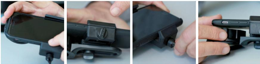
**2** Una volta posizionato lo smartphone, allineiamo la ghiera dell'adattatore con la fotocamera dello smartphone (la posizione della fotocamera varia in base al modello).
