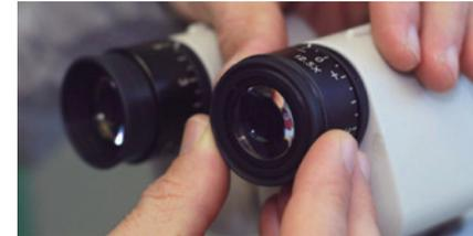
**2** Sistemare l'adattatore sull'oculare. Apriamo al massimo la testa mobile (andare fino alla direzione "loose" posteriormente; dopo averlo sistemato chiuderlo (fino alla posizione "lock").
